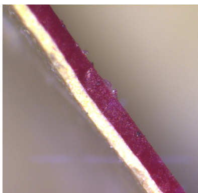
Рис. 8. Торцевая поверхность частицы ЛКП автомобиля, полученного в заводских условиях (увеличение микроскопа – 98х). Слой светлого ЛКП – слой грунтовки; слой красного цвета – слой эмали
