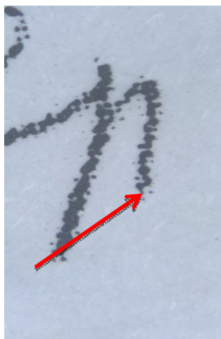
Рис. 8. Изображение утраты заключительной части 2-го элемента строчной буквы «р» при выполнении рукописных записей с помощью компьютерной программы FontCreator
